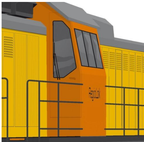
Rys. 6. Nowe drzwi kabiny maszynisty.
